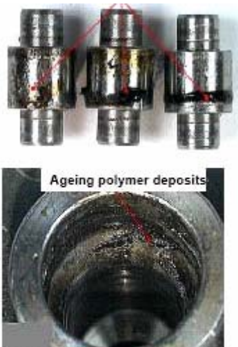
Abb. 3 Ablagerungen von Polymeren durch Einsatz von Biodiesel mit zu geringer Oxidationsstabilität, Quelle Robert Bosch GmbH
