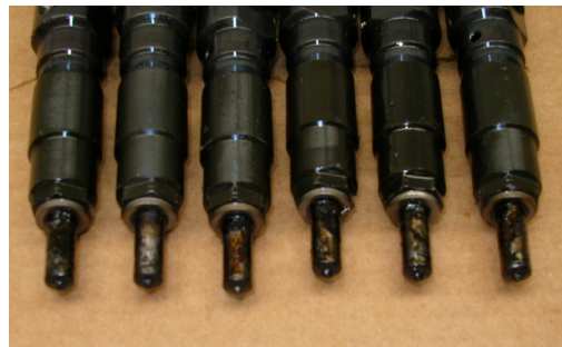
Abb. 2: Verkockungen an Einspritzdüsen im Sojaölbetrieb
