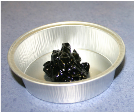
Abb. 4: Eingedicktes Schmieröl nach Sojaölschaden
