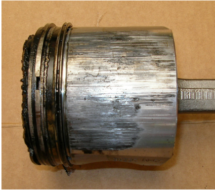
Abb. 3: Ablagerungen an Kolbenringen nach Sojaölschaden
