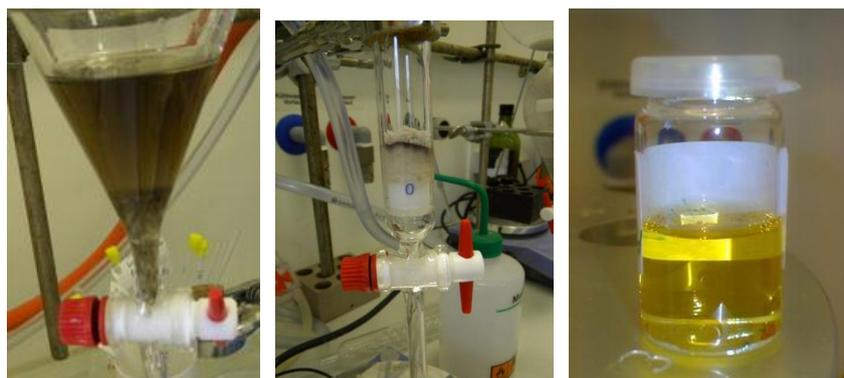
Abb. 2-8: Bildung eines dunklen Niederschlags an der Unterseite des Scheidetrichters (links); Katalysator-Rückstand auf Silicagel (Mitte); katalysatorfreier Biodiesel (rechts)
