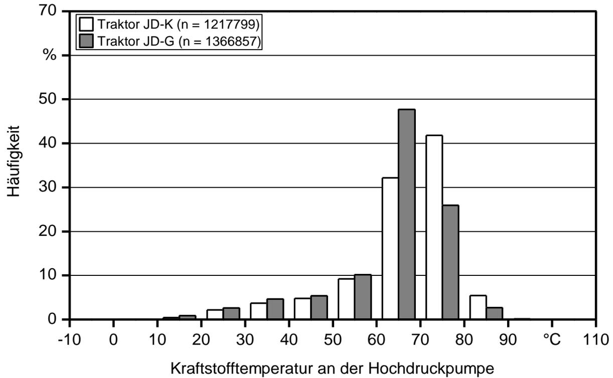
Abbildung 16: Häufigkeitsverteilung der Kraftstofftemperatur an der Hochdruckpumpe der beiden John Deere Traktoren während des Feldbetriebs 2010
