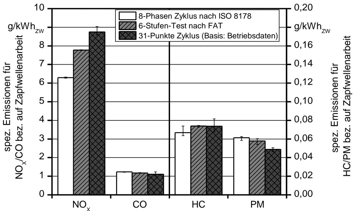
Abbildung 49: Spezifische Emissionen von NO<sub>x</sub>, CO, HC und Partikelmasse des Traktors JD-K unter Anwendung verschiedener Prüfzyklen
