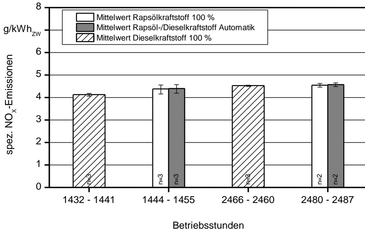
Abbildung 45: Spezifische  $\text{NO}_x$ -Emissionen des Traktors FE-N im Betrieb mit Dieselkraftstoff, Rapsölkraftstoff und Rapsöl-/Dieselkraftstoff bei aktiviertem Kraftstoffmanagementsystem vor und nach dem Feldeinsatz im Jahr 2010
