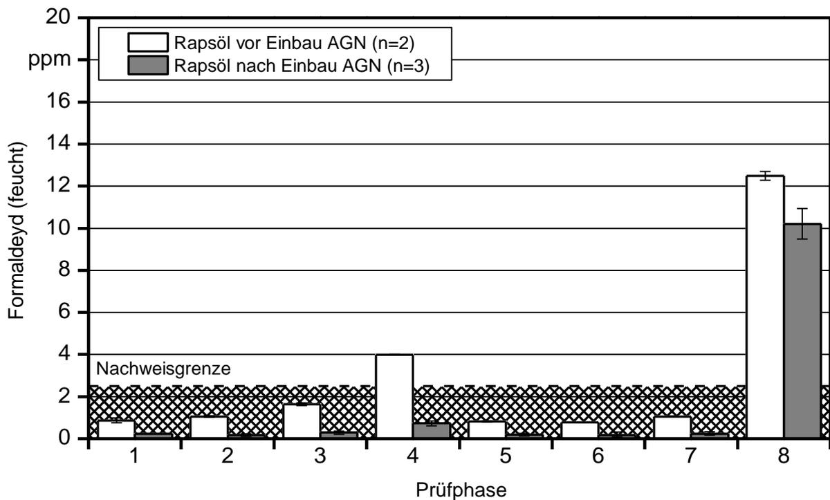
Abbildung 62: Formaldehyd-Emissionen des Traktors JD-G vor und nach Einbau einer Abgasnachbehandlungsanlage (n = Anzahl der Messungen)
