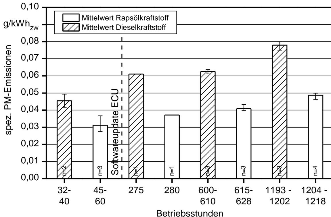
Abbildung 36: Spezifische Partikelmasse-Emissionen (PM) des Traktors JD-K im Betrieb mit Rapsöl- und Dieseldieselkraftstoff während des Berichtszeitraumes
