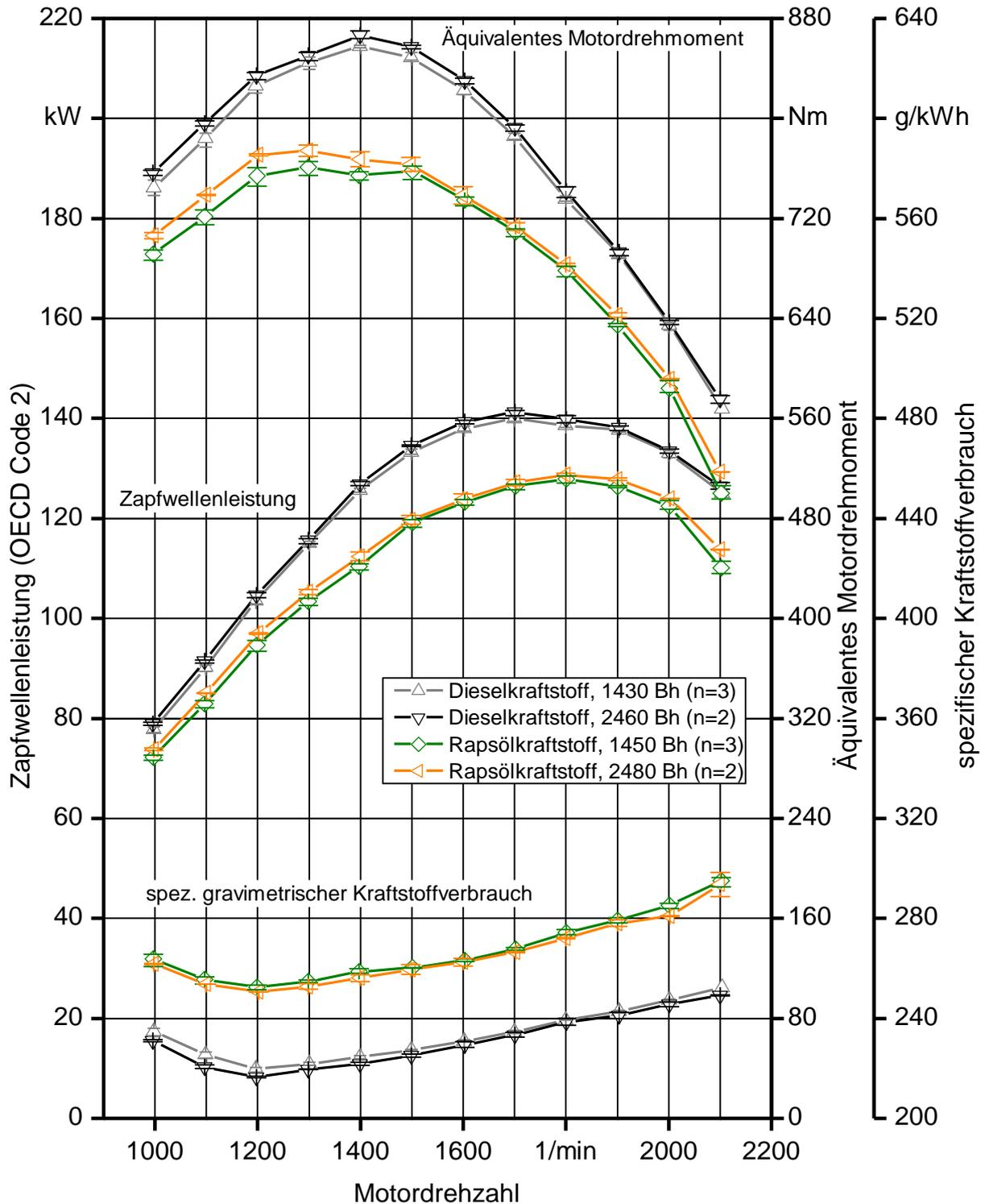
Abbildung 32: Mittelwerte und Spannweiten von Zapfwellenleistung, äquivalentem Motordrehmoment und spezifischem Kraftstoffverbrauch des Traktors FE-N im Betrieb mit Rapsöl- und Dieselkraftstoff ( $n$  = Anzahl der Messungen)
