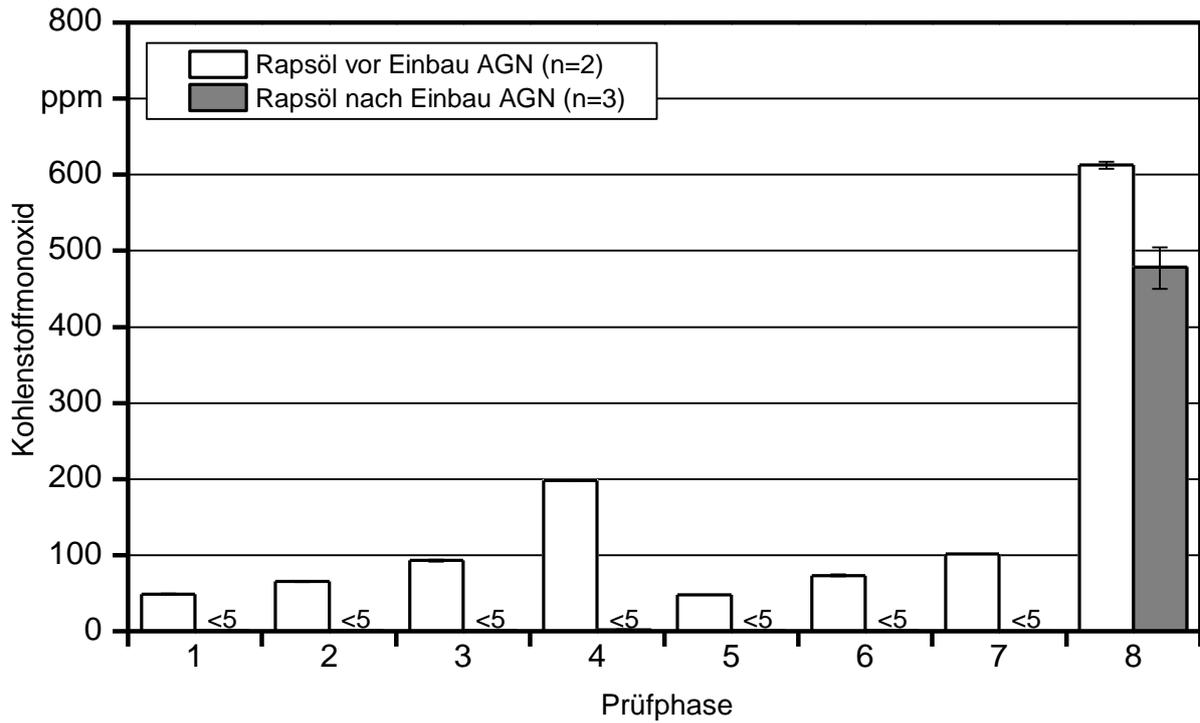
Abbildung 56: Kohlenstoffmonoxid-Konzentrationen bei den einzelnen Prüfphasen vor und nach dem Einbau des Abgasnachbehandlungssystems in Traktor JD-G
