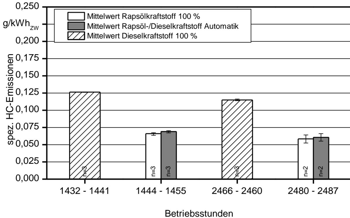
Abbildung 47: Spezifische HC-Emissionen des Traktors FE-N im Betrieb mit Dieselkraftstoff, Rapsölkraftstoff und Rapsöl-/Dieselkraftstoff bei aktiviertem Kraftstoffmanagementsystem vor und nach dem Feldeinsatz im Jahr 2010
