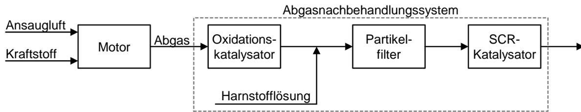
Abbildung 7: Schematische Übersicht zum Aufbau des Abgasnachbehandlungssystems
