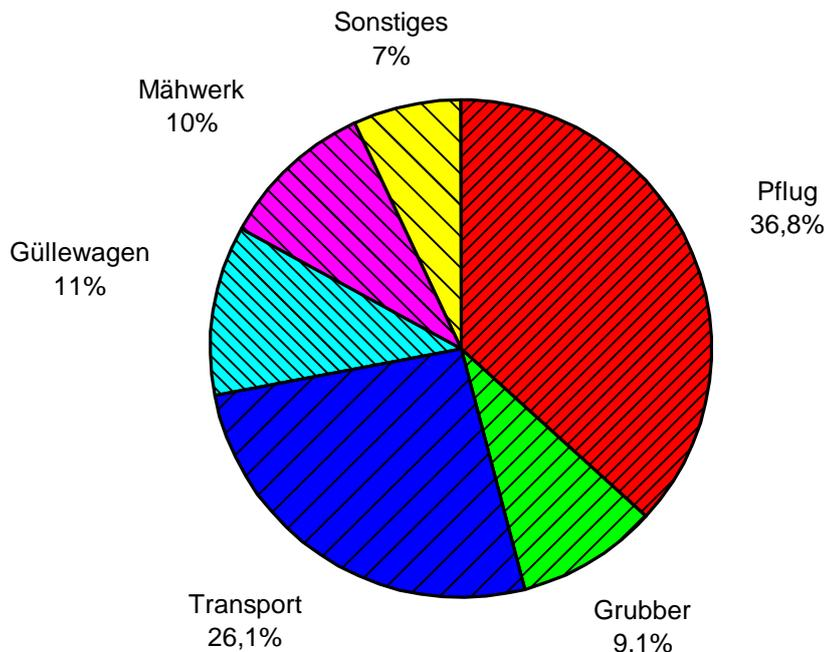
Abbildung 10: Anteil der Arbeiten des Traktors FE-A in den Betriebsjahren 2010 bis 2011
