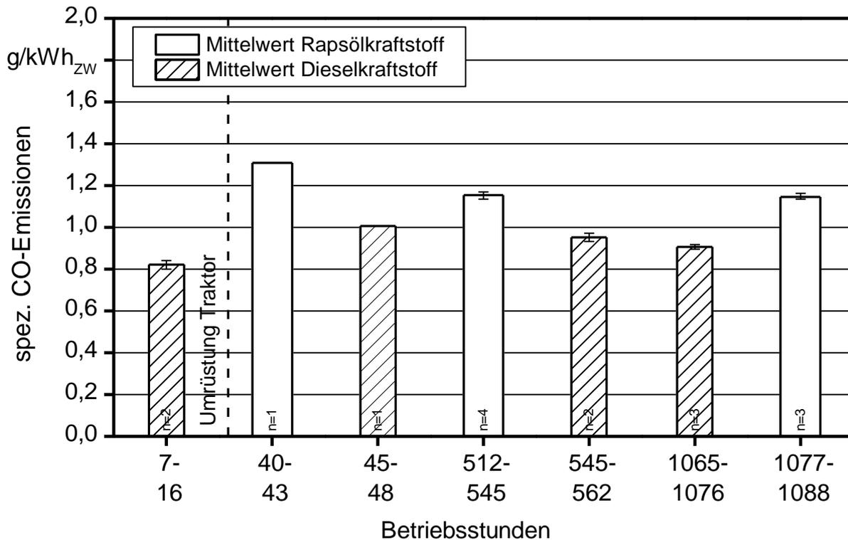
Abbildung 38: Spezifische CO-Emissionen des Traktors JD-G im Betrieb mit Dieselkraftstoff im Originalzustand, sowie Diesel- und Rapsölkraftstoff nach der Umrüstung während des Berichtszeitraumes
