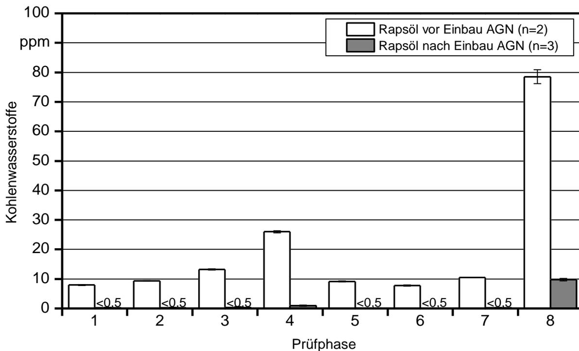
Abbildung 58: Kohlenwasserstoff-Konzentrationen bei den einzelnen Prüfphasen vor und nach dem Einbau des Abgasnachbehandlungssystems in Traktor JD-G
