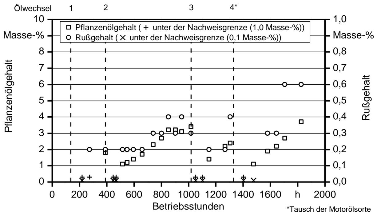
Abbildung 21: Verlauf des Kraftstoff- und Rußgehalts des Motorenöls des Traktors JD-K über den Versuchszeitraum
