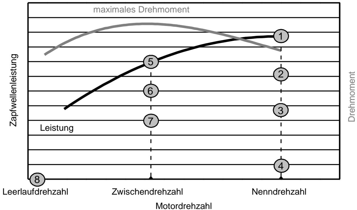
Abbildung 5: Schematische Darstellung der acht Prüfphasen des C1-Prüfzyklus nach ISO 8178-4
