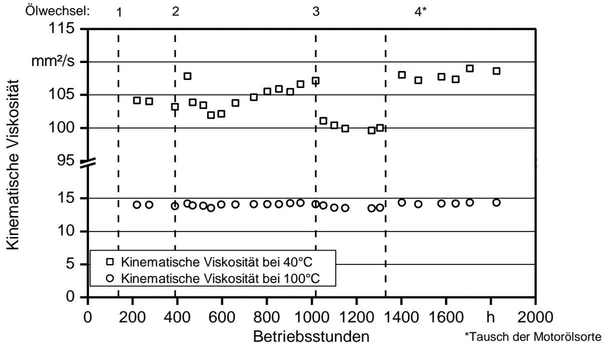
Abbildung 22: Verlauf der kinematischen Viskosität des Motorenöls bei 40 °C und bei 100 °C des Traktors JD-K über den Versuchszeitraum
