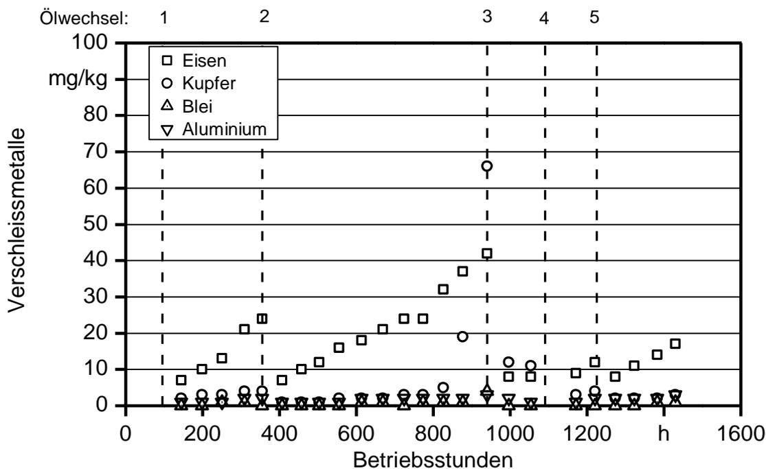
Abbildung 27: Verlauf der Elementgehalte der Verschleißkomponenten Eisen, Kupfer, Blei und Aluminium des Motorenöls des Traktors JD-G über den Versuchszeitraum
