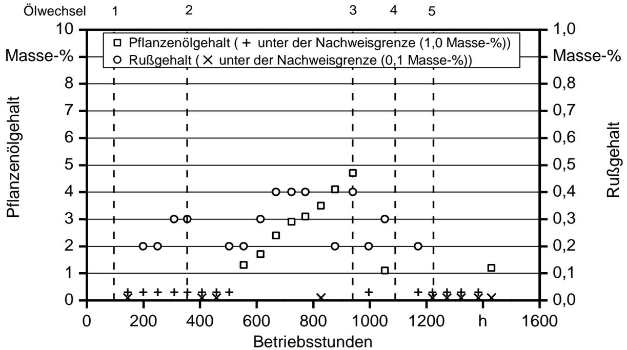
Abbildung 25: Verlauf des Kraftstoff- und Rußgehalts des Motorenöls des Traktors JD-G über den Versuchszeitraum
