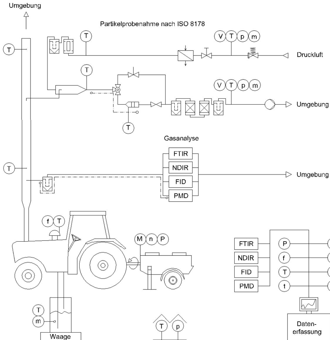
Abbildung 4: Aufbau des Emissionsprüfstands am Technologie- und Förderzentrum (TFZ)
