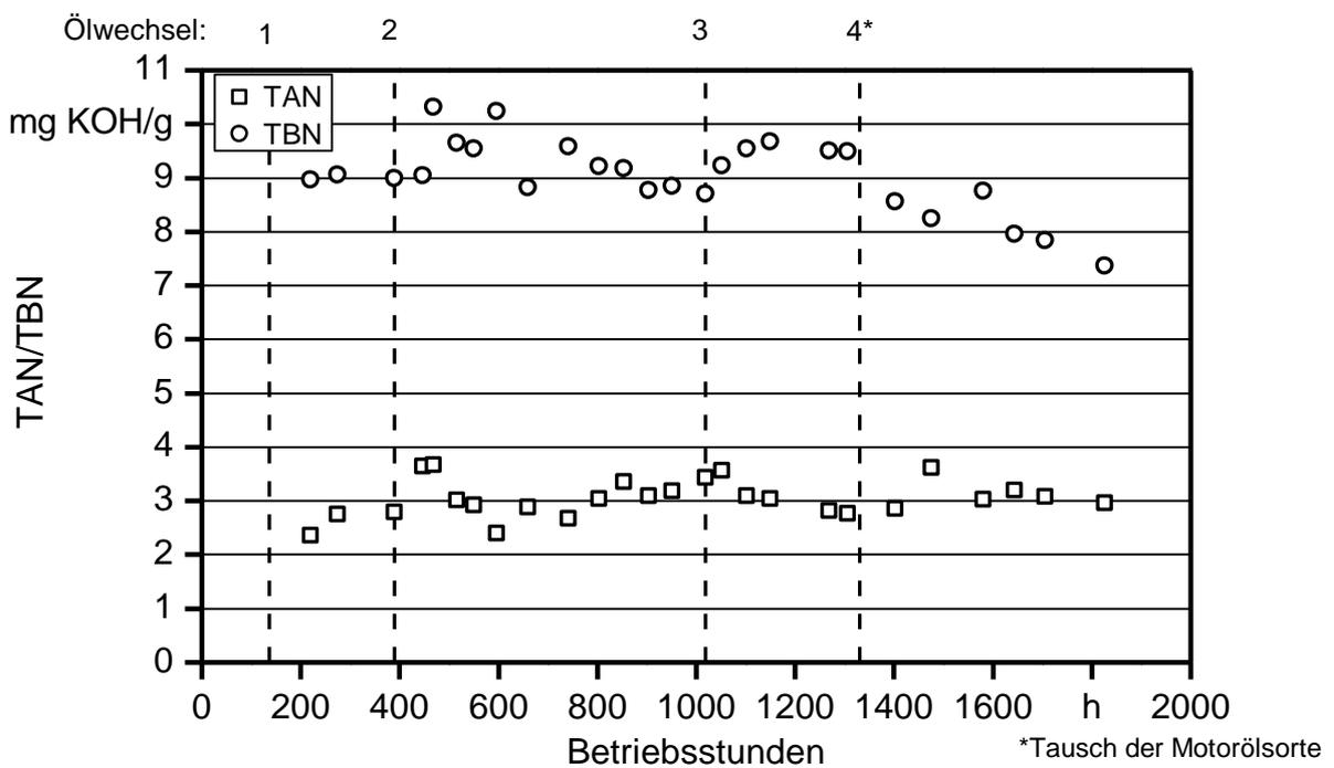
Abbildung 24: Total Acid Number (TAN) und Total Base Number (TAN) des Motorenöls des Traktors JD-K über den Versuchszeitraum
