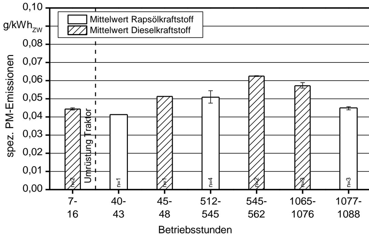
Abbildung 40: Spezifische Partikelmasse-Emissionen des Traktors JD-G im Betrieb mit Dieselkraftstoff im Originalzustand, sowie Diesel- und Rapsölkraftstoff nach der Umrüstung während des Berichtszeitraumes
