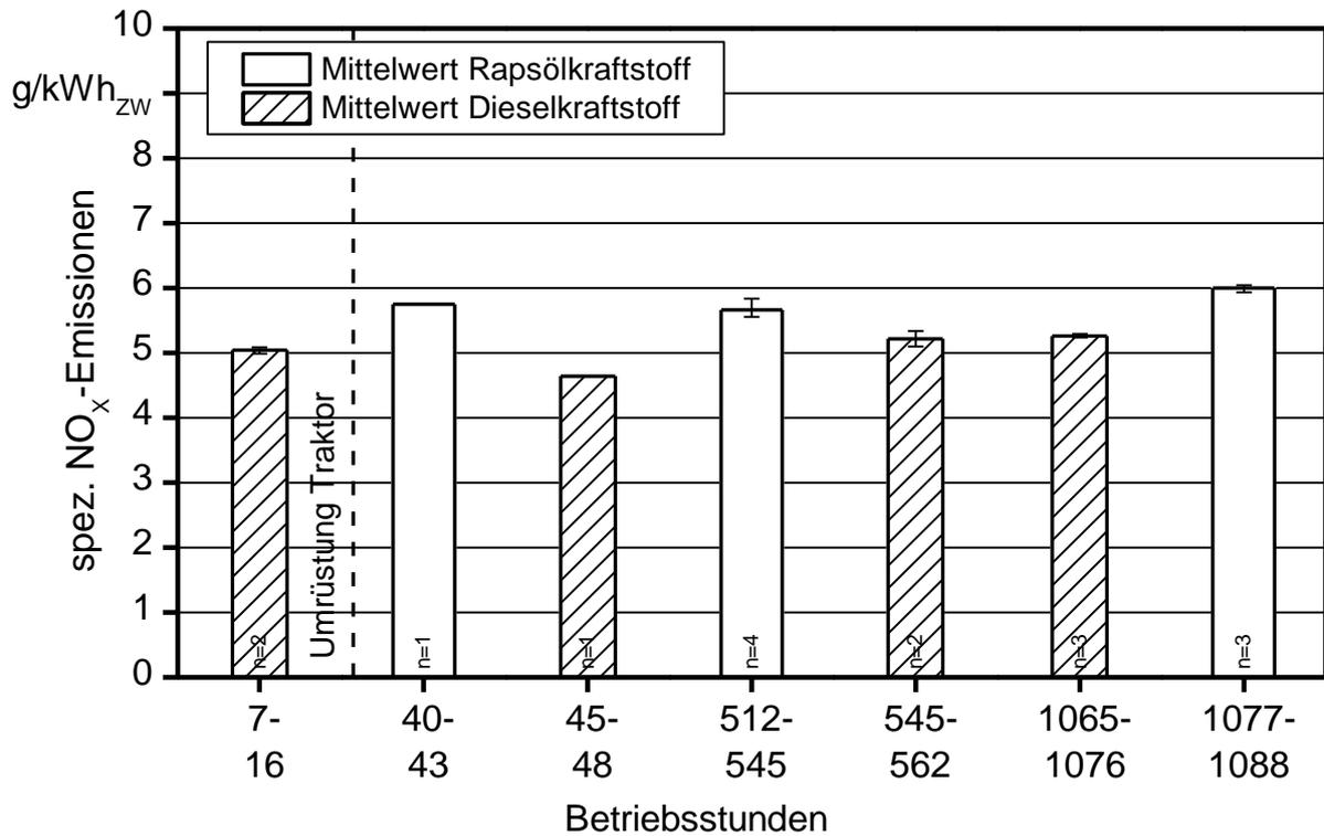
Abbildung 37: Spezifische  $\text{NO}_x$ -Emissionen des Traktors JD-G im Betrieb mit Dieselkraftstoff im Originalzustand, sowie Diesel- und Rapsölkraftstoff nach der Umrüstung während des Berichtszeitraumes
