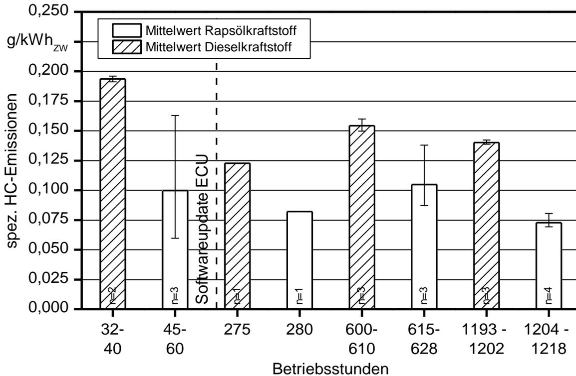
Abbildung 35: Spezifische HC-Emissionen des Traktors JD-K im Betrieb mit Rapsöl- und Dieselmotorkraftstoff während des Berichtszeitraumes
