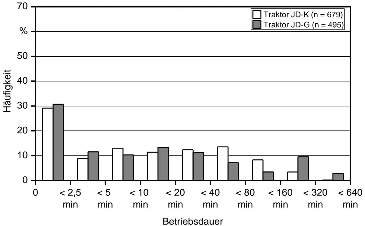
Abbildung 12: Häufigkeitsverteilung der Betriebsdauer der beiden John Deere Traktoren im Feldbetrieb 2010
