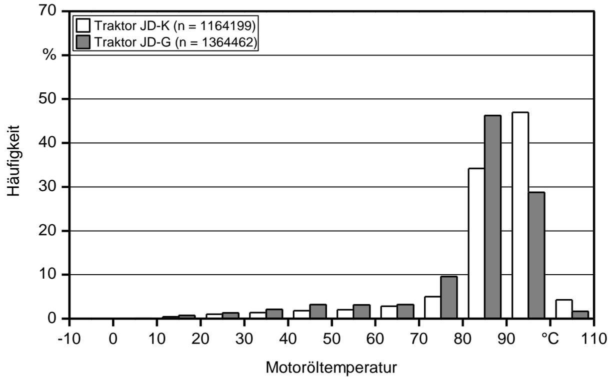
Abbildung 19: Häufigkeitsverteilung der Motoröltemperatur der beiden John Deere Traktoren während des Feldbetriebs 2010
