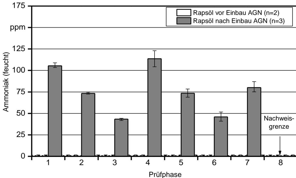
Abbildung 60: Ammoniak-Emissionen des Traktors JD-G vor und nach Einbau einer Abgasnachbehandlungsanlage ( $n$  = Anzahl der Messungen)
