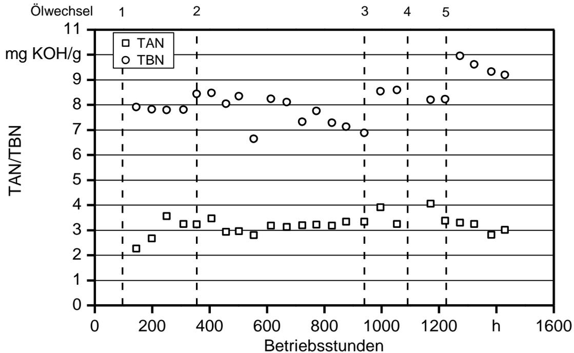
Abbildung 28: Total Acid Number (TAN) und Total Base Number (TAN) des Motorenöls des Traktors JD-G über den Versuchszeitraum
