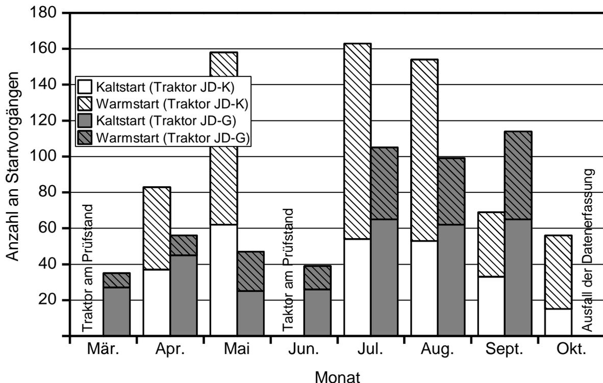
Abbildung 13: Anzahl an Startvorgängen der John Deere Traktoren im Feldbetrieb 2010 (Kaltstart bei einer Motoröltemperatur von < 50 °C)
