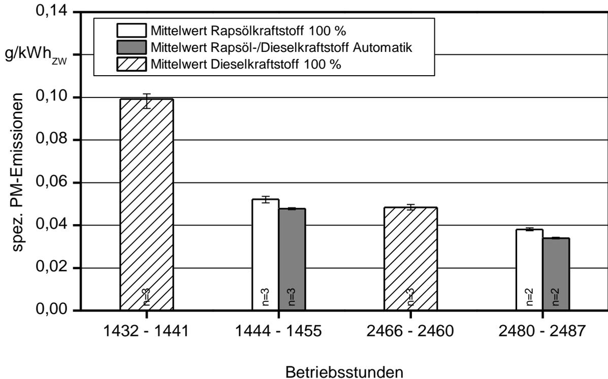
Abbildung 48: Spezifische Partikelmasse-Emissionen des Traktors FE-N im Betrieb mit Dieselkraftstoff, Rapsölkraftstoff und Rapsöl-/Dieselkraftstoff bei aktiviertem Kraftstoffmanagementsystem vor und nach dem Feldeinsatz im Jahr 2010
