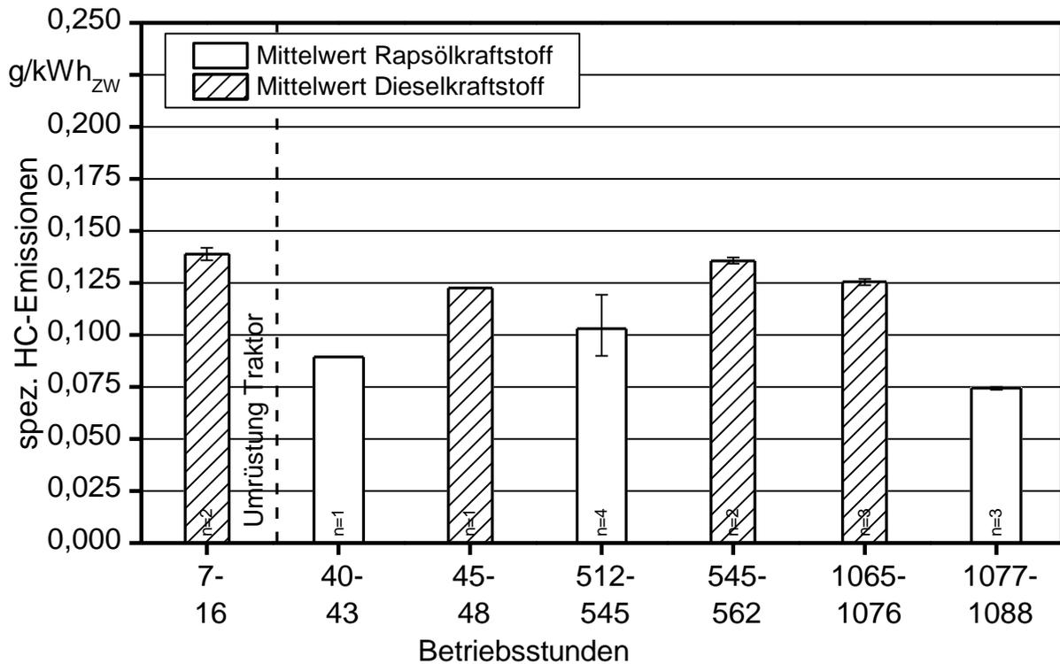
Abbildung 39: Spezifische HC-Emissionen des Traktors JD-G im Betrieb mit Dieseldkraftstoff im Originalzustand, sowie Dieseld- und Rapsölkraftstoff nach der Umrüstung während des Berichtszeitraumes
