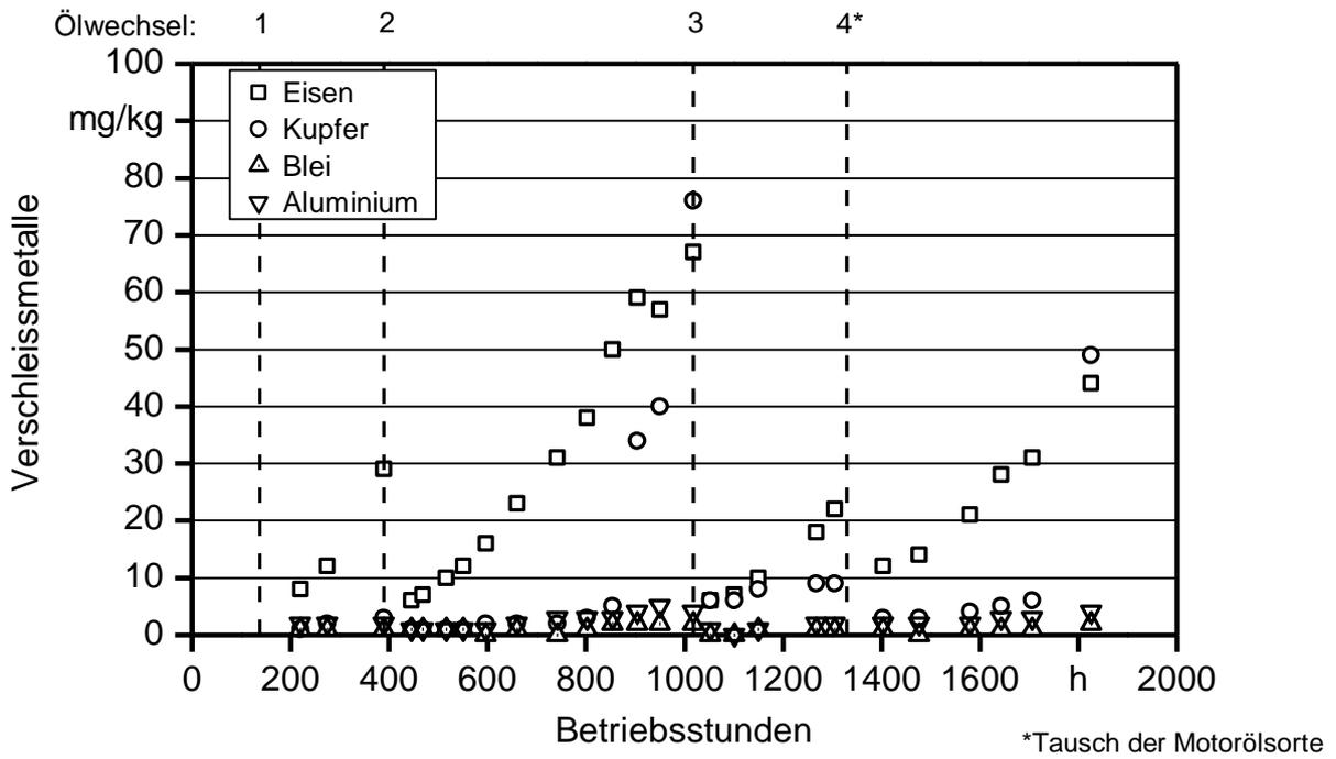
Abbildung 23: Verlauf der Elementgehalte der Verschleißkomponenten Eisen, Kupfer, Blei und Aluminium des Motorenöls des Traktors JD-K über den Versuchszeitraum
