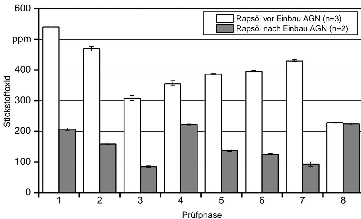
Abbildung 52: Stickstoffoxid-Konzentrationen bei den einzelnen Prüfphasen vor und nach dem Einbau des Abgasnachbehandlungssystems in Traktor JD-K
