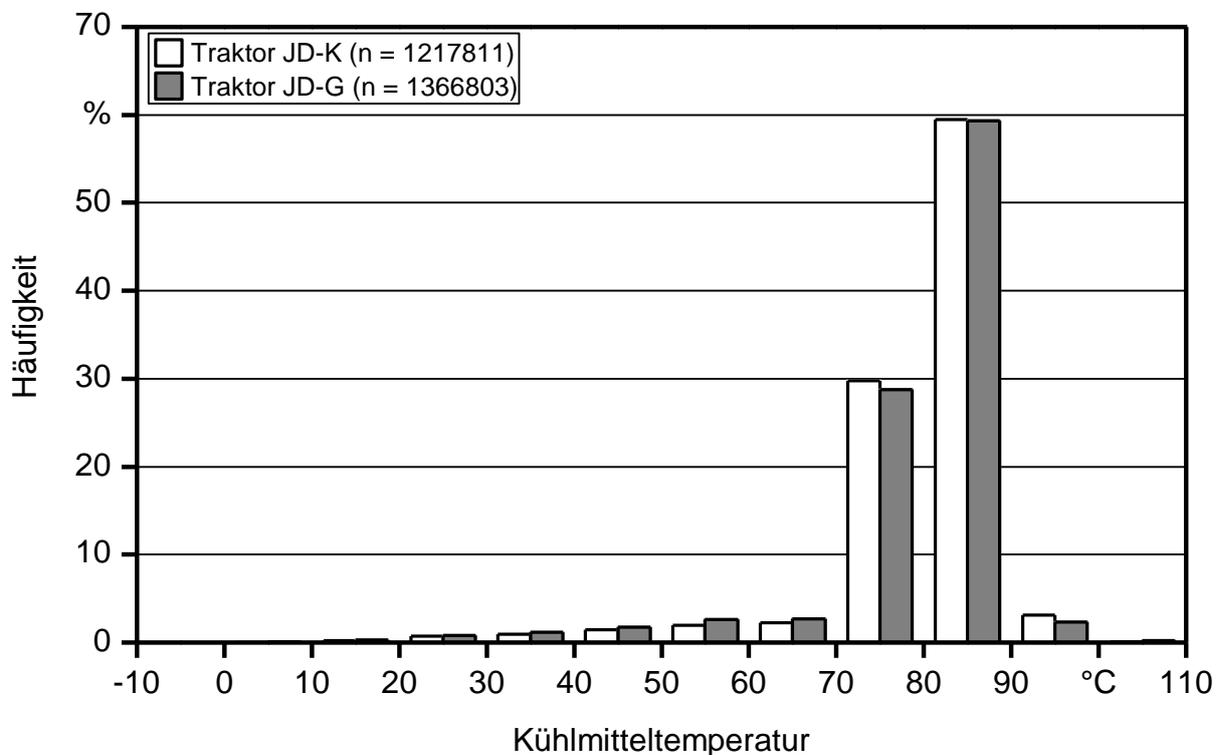
Abbildung 18: Häufigkeitsverteilung der Kühlmitteltemperatur der beiden John Deere Traktoren während des Feldbetriebs 2010
