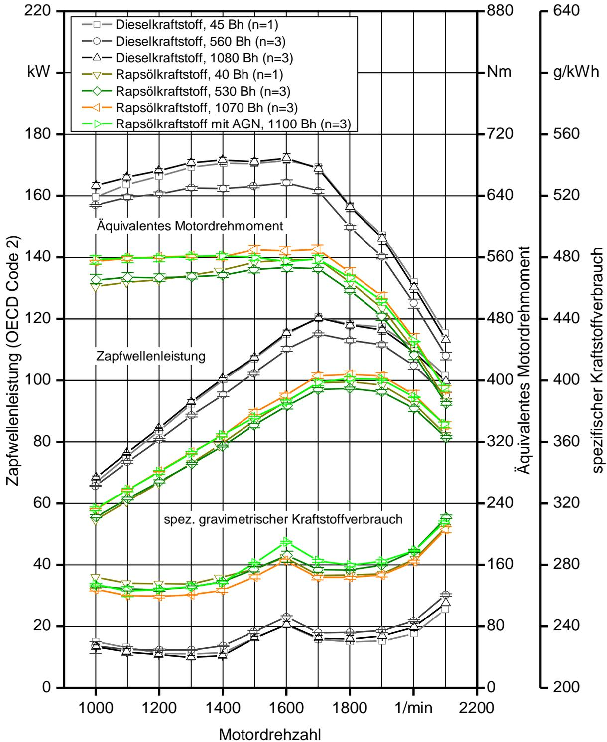
Abbildung 30: Mittelwerte und Spannweiten von Zapfwellenleistung, äquivalentem Motordrehmoment und spezifischem Kraftstoffverbrauch des Traktors JD-G im Betrieb mit Rapsöl- und Dieselmotorkraftstoff ( $n$  = Anzahl der Messungen)
