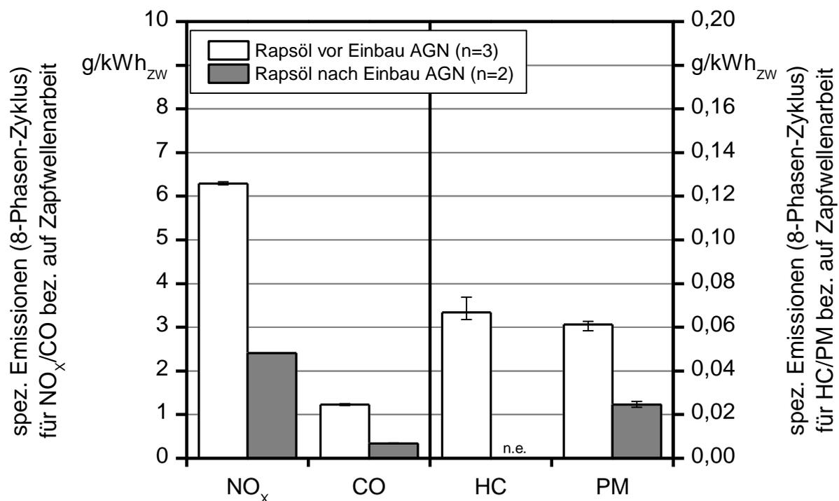
Abbildung 50: Spezifische Emissionen von  $\text{NO}_x$ , CO, HC und Partikelmasse des Traktors JD-K vor und nach Einbau einer Abgasnachbehandlungsanlage
