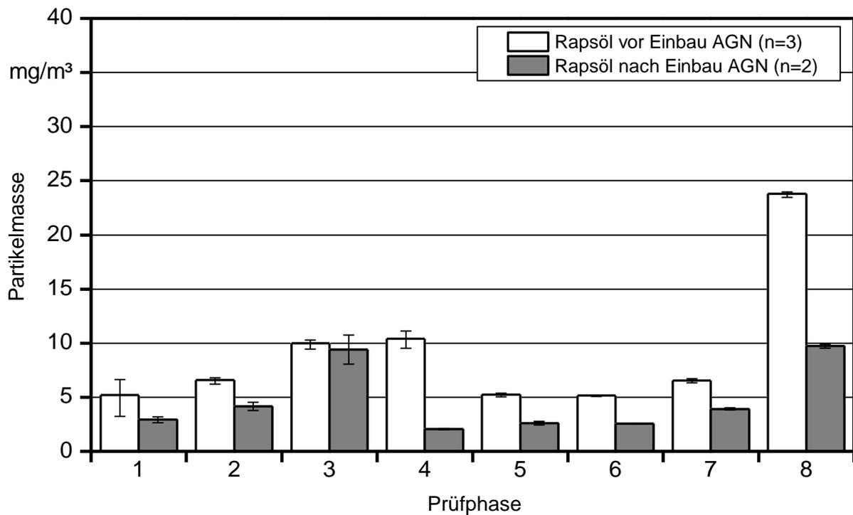
Abbildung 54: Partikelmasse-Konzentrationen bei den einzelnen Prüfphasen vor und nach dem Einbau des Abgasnachbehandlungssystems in Traktor JD-K
