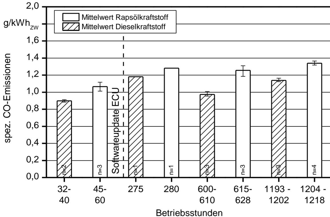
Abbildung 34: Spezifische CO-Emissionen des Traktors JD-K im Betrieb mit Rapsöl- und Dieseldieselkraftstoff während des Berichtszeitraumes
