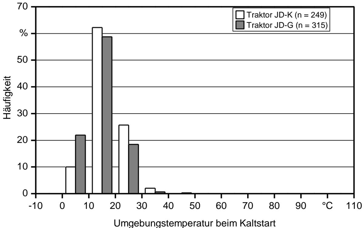
Abbildung 14: Umgebungstemperatur bei den Kaltstartvorgängen der John Deere Traktoren im Feldbetrieb 2010
