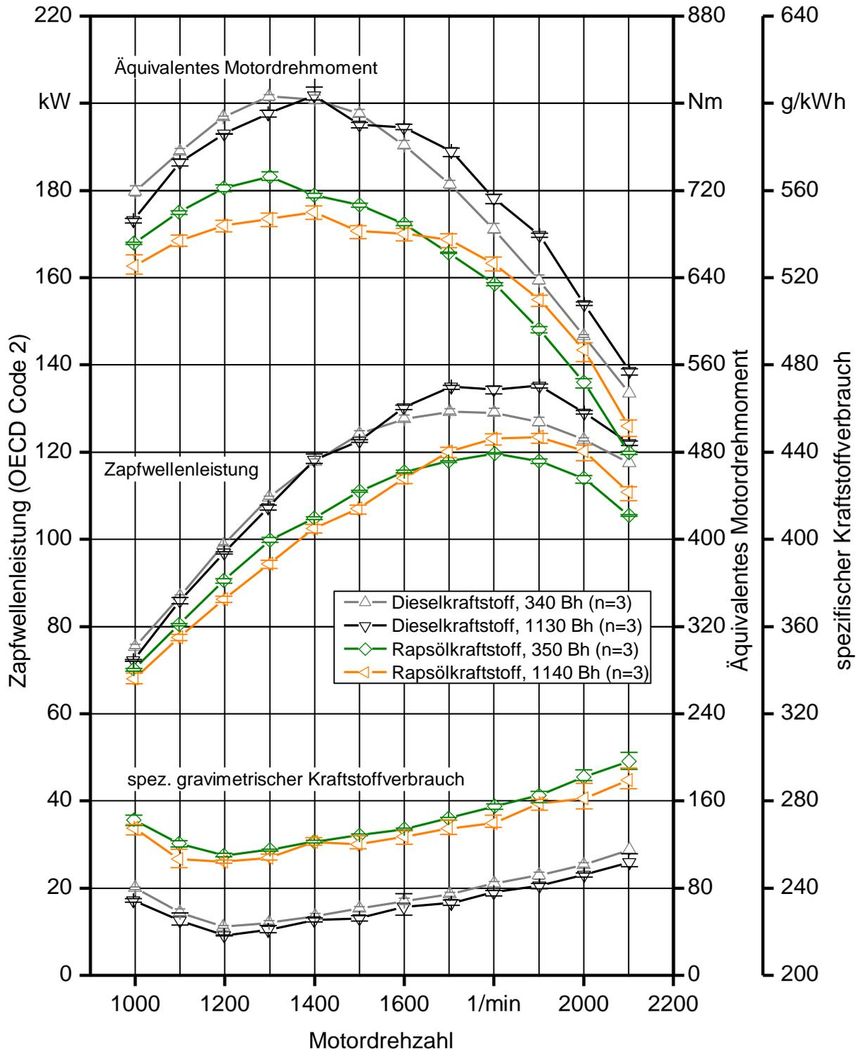
Abbildung 31: Mittelwerte und Spannweiten von Zapfwellenleistung, äquivalentem Motordrehmoment und spezifischem Kraftstoffverbrauch des Traktors FE-A im Betrieb mit Rapsöl- und Dieselkraftstoff ( $n$  = Anzahl der Messungen)
