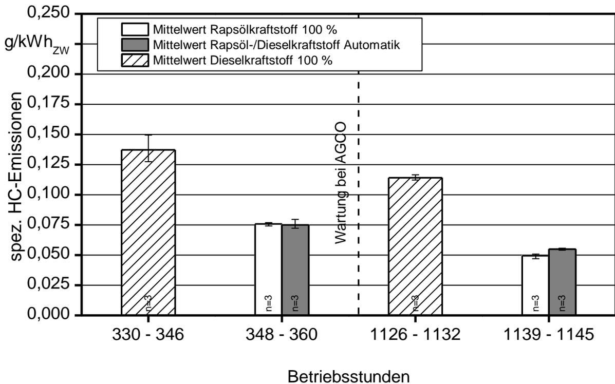
Abbildung 43: Spezifische HC-Emissionen des Traktors FE-A im Betrieb mit Dieselkraftstoff, Rapsölkraftstoff und Rapsöl-/Dieselkraftstoff bei aktiviertem Kraftstoffmanagementsystem vor und nach dem Feldeinsatz im Jahr 2010
