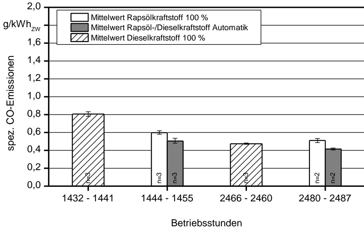
Abbildung 46: Spezifische CO-Emissionen des Traktors FE-N im Betrieb mit Dieselkraftstoff, Rapsölkraftstoff und Rapsöl-/Dieselkraftstoff bei aktiviertem Kraftstoffmanagementsystem vor und nach dem Feldeinsatz im Jahr 2010
