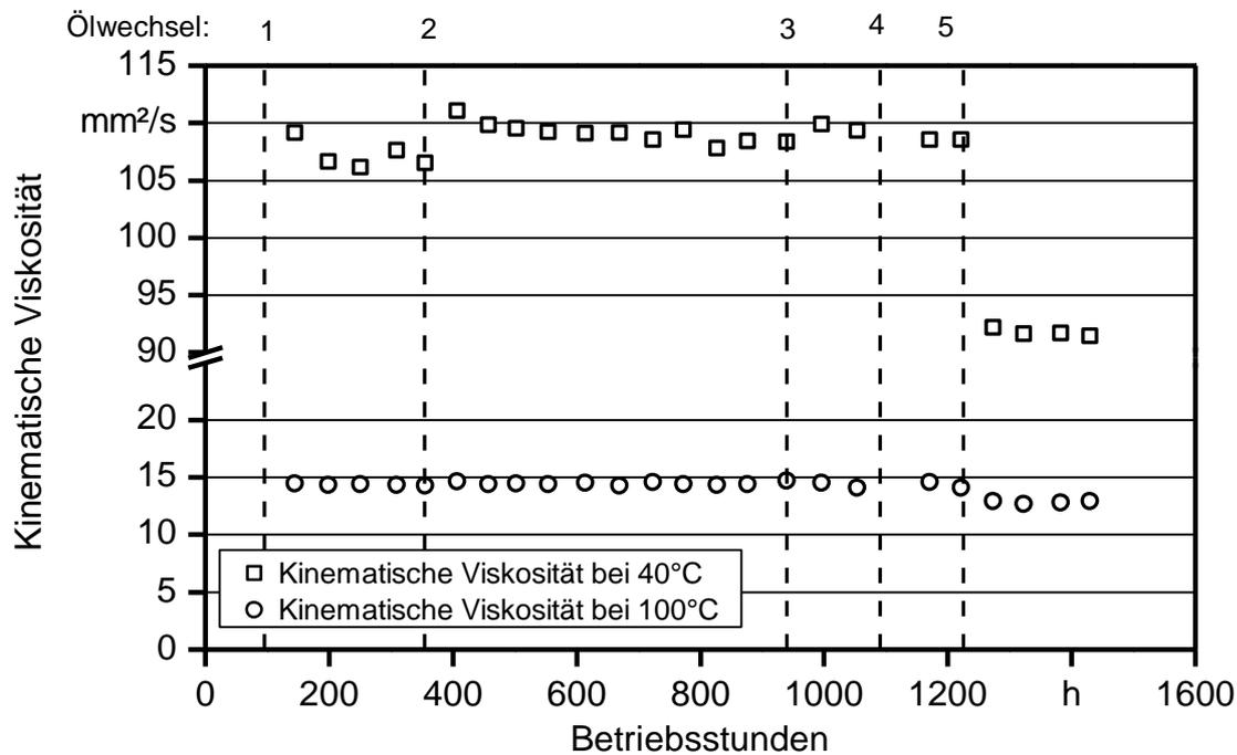
Abbildung 26: Verlauf der kinematischen Viskosität des Motorenöls bei 40 °C und bei 100 °C des Traktors JD-G über den Versuchszeitraum
