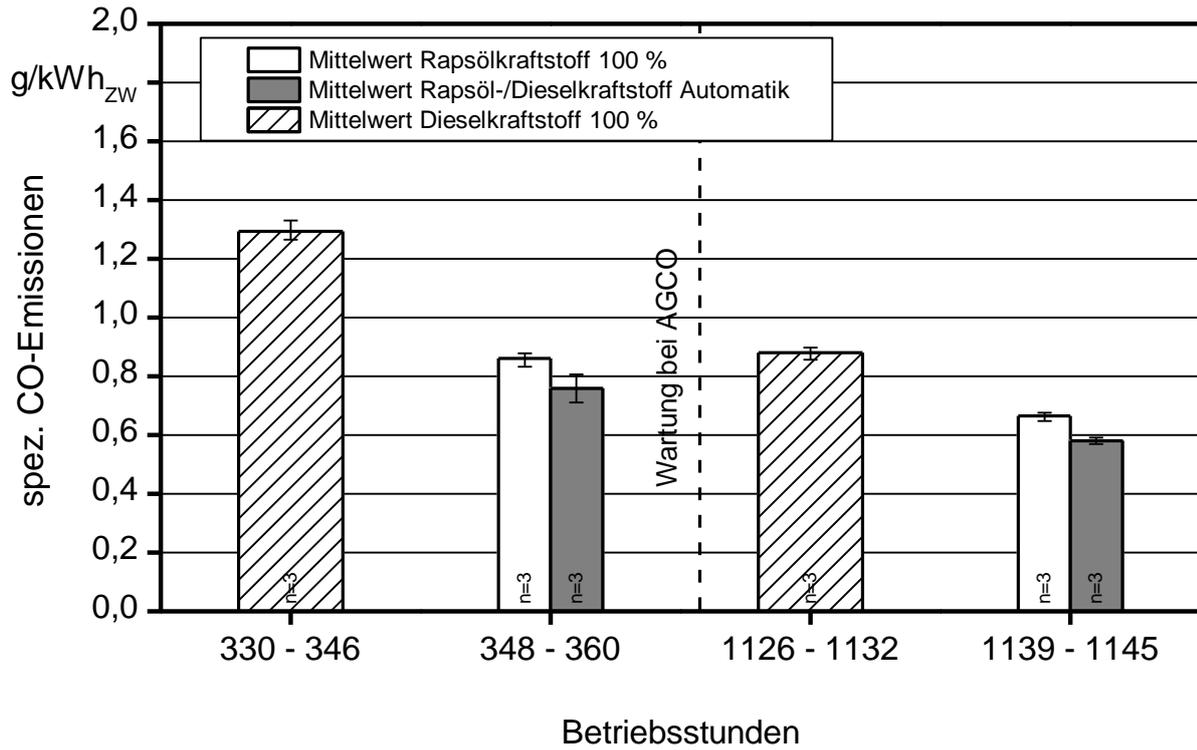
Abbildung 42: Spezifische CO-Emissionen des Traktors FE-A im Betrieb mit Dieselkraftstoff, Rapsölkraftstoff und Rapsöl-/Dieselkraftstoff bei aktiviertem Kraftstoffmanagementsystem vor und nach dem Feldeinsatz im Jahr 2010
