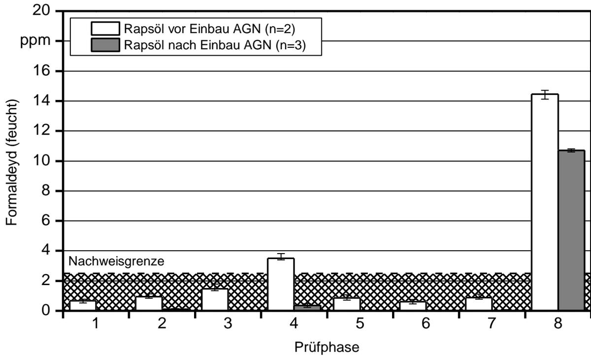
Abbildung 61: Formaldehyd-Emissionen des Traktors JD-K vor und nach Einbau einer Abgasnachbehandlungsanlage (n = Anzahl der Messungen)
