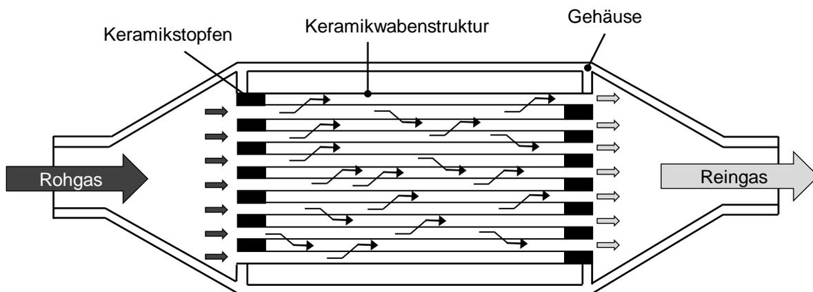
Abbildung 2: Schematischer Aufbau eines geschlossenen keramischen Partikelfilters
