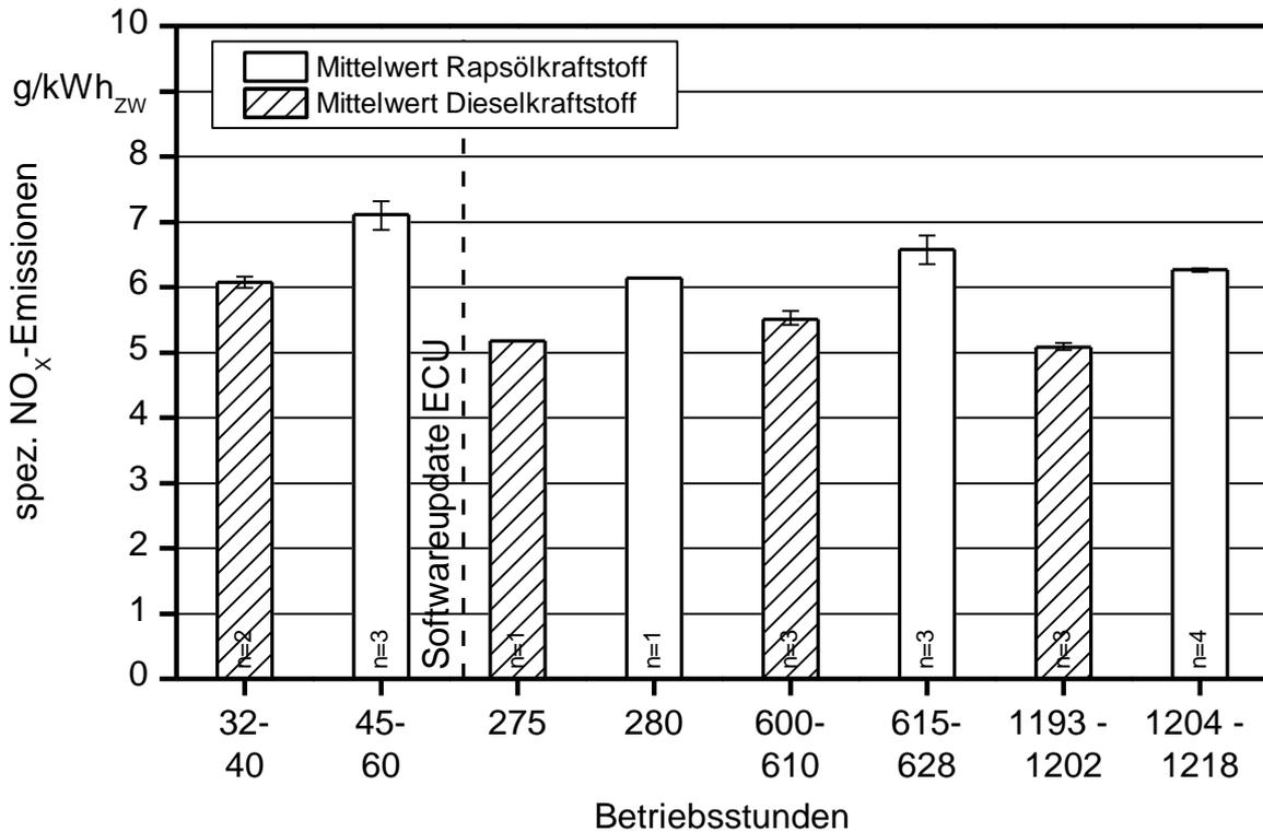
Abbildung 33: Spezifische  $\text{NO}_x$ -Emissionen des Traktors JD-K im Betrieb mit Rapsöl- und Dieseldieselfuel während des Berichtszeitraumes
