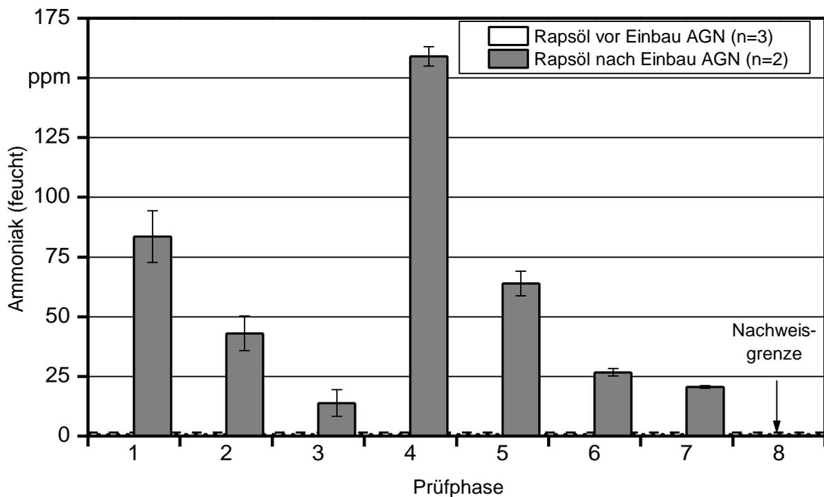
Abbildung 59: Ammoniak-Emissionen des Traktors JD-K vor und nach Einbau einer Abgasnachbehandlungsanlage ( $n$  = Anzahl der Messungen)
