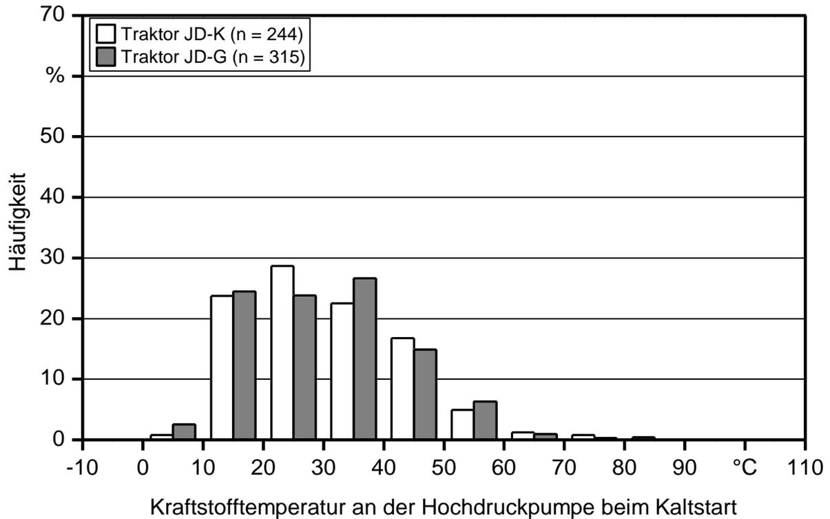
Abbildung 15: Häufigkeitsverteilung der Kraftstofftemperatur an der Hochdruckpumpe bei den Kaltstartvorgängen der beiden John Deere Traktoren
