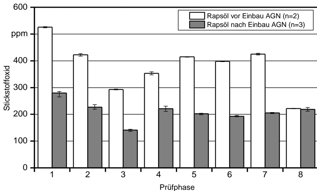
Abbildung 55: Stickstoffoxid-Konzentrationen bei den einzelnen Prüfphasen vor und nach dem Einbau des Abgasnachbehandlungssystems in Traktor JD-G
