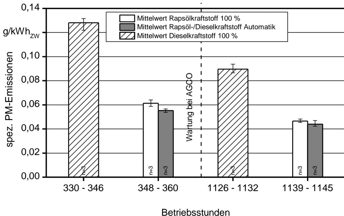
Abbildung 44: Spezifische Partikelmasse-Emissionen des Traktors FE-A im Betrieb mit Dieselkraftstoff, Rapsölkraftstoff und Rapsöl-/Dieselkraftstoff bei aktiviertem Kraftstoffmanagementsystem vor und nach dem Feldeinsatz im Jahr 2010
