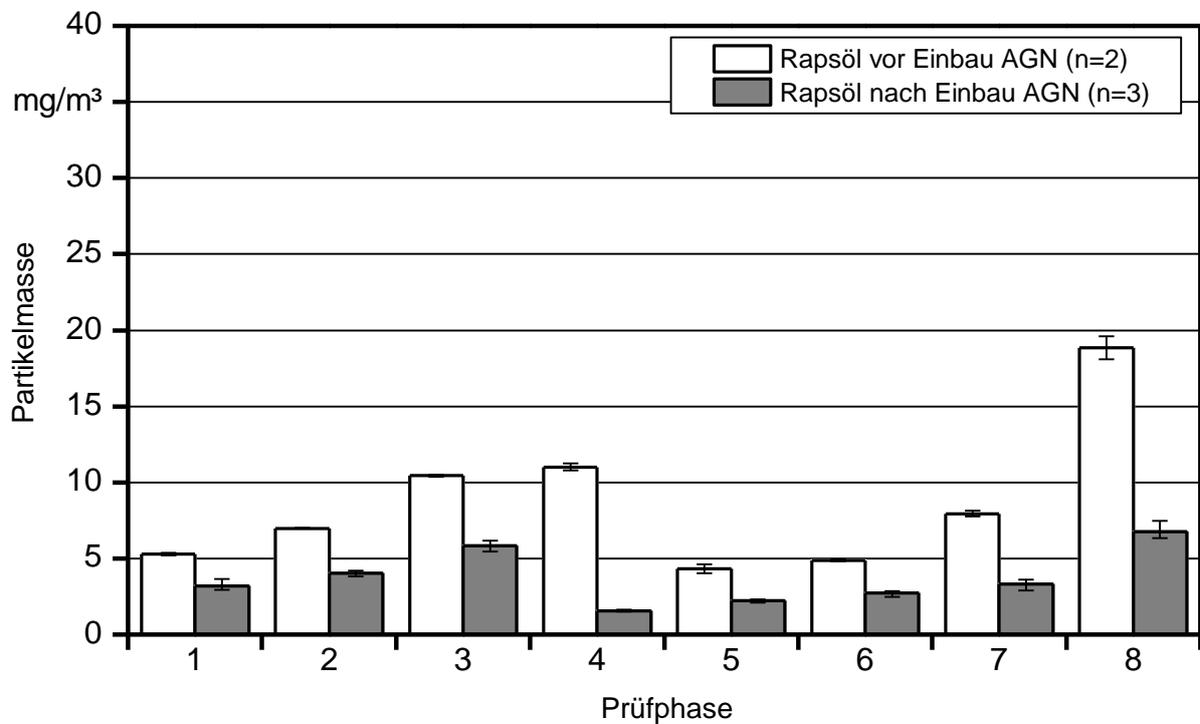
Abbildung 57: Partikelmasse-Konzentrationen bei den einzelnen Prüfphasen vor und nach dem Einbau des Abgasnachbehandlungssystems in Traktor JD-G
