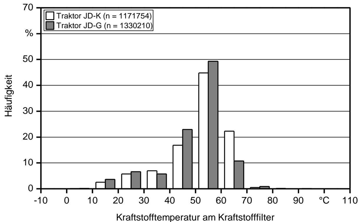
Abbildung 17: Häufigkeitsverteilung der Kraftstofftemperatur am Kraftstofffilter der beiden John Deere Traktoren während des Feldbetriebs 2010
