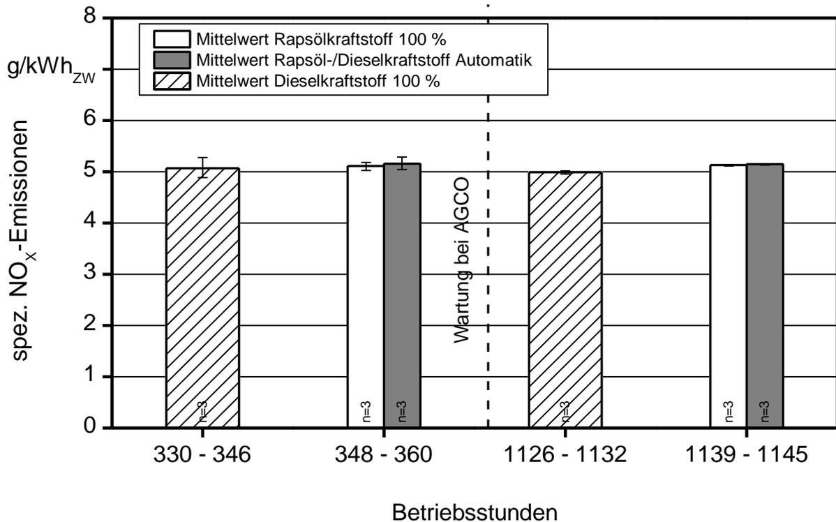
Abbildung 41: Spezifische  $\text{NO}_x$ -Emissionen des Traktors FE-A im Betrieb mit Dieselkraftstoff, Rapsölkraftstoff und Rapsöl-/Dieselkraftstoff bei aktiviertem Kraftstoffmanagementsystem vor und nach dem Feldeinsatz im Jahr 2010
