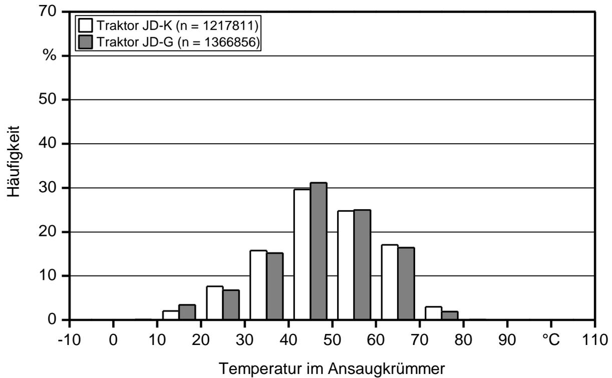
Abbildung 20: Häufigkeitsverteilung der Temperatur im Ansaugkrümmer der beiden John Deere Traktoren während des Feldbetriebs 2010
