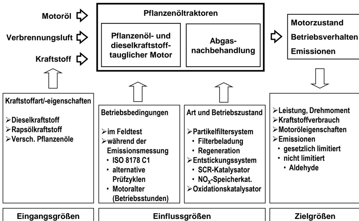
Abbildung 1: Schematische Darstellung von Eingangs-, Einfluss- und Zielgrößen für die Untersuchungen zum Einsatz von Rapsölmotor in Traktoren
