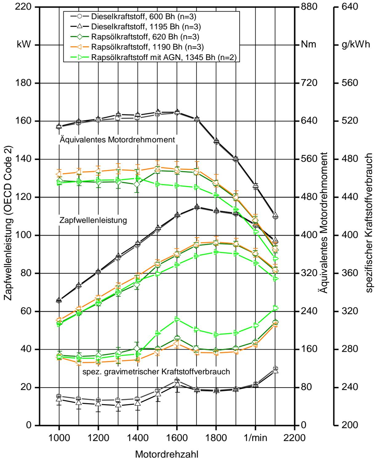
Abbildung 29: Mittelwerte und Spannweiten von Zapfwellenleistung, äquivalentem Motordrehmoment und spezifischem Kraftstoffverbrauch des Traktors JD-K im Betrieb mit Rapsöl- und Dieselkraftstoff ( $n$  = Anzahl der Messungen)
