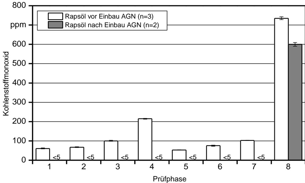
Abbildung 53: Kohlenstoffmonoxid-Konzentrationen bei den einzelnen Prüfphasen vor und nach dem Einbau des Abgasnachbehandlungssystems in Traktor JD-K
