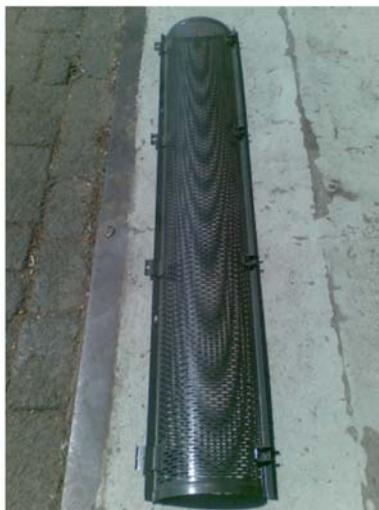
Abb. 2.4: Einsatz eines Spezialsiebes in die Querförderschnecke des Mähdreschers (Claas-Kornmulde gelocht)
