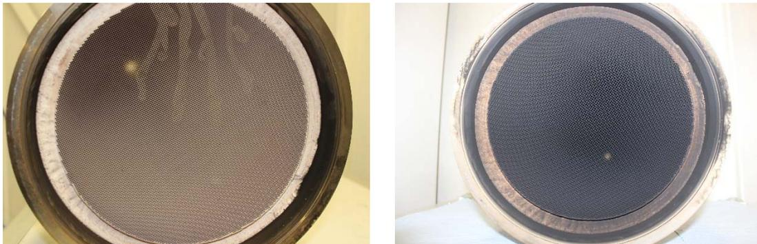
**Abbildung 5-37: Bilder vom DOC (links vor und rechts nach 100 Stunden Niederlastzyklus)**
