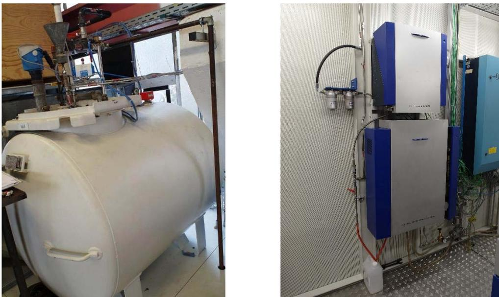
**Abbildung 4-18 und Abbildung 4-19: Tagestank am Motorprüfstand und Kraftstoffwaage mit Kraftstoffkonditionierung**
