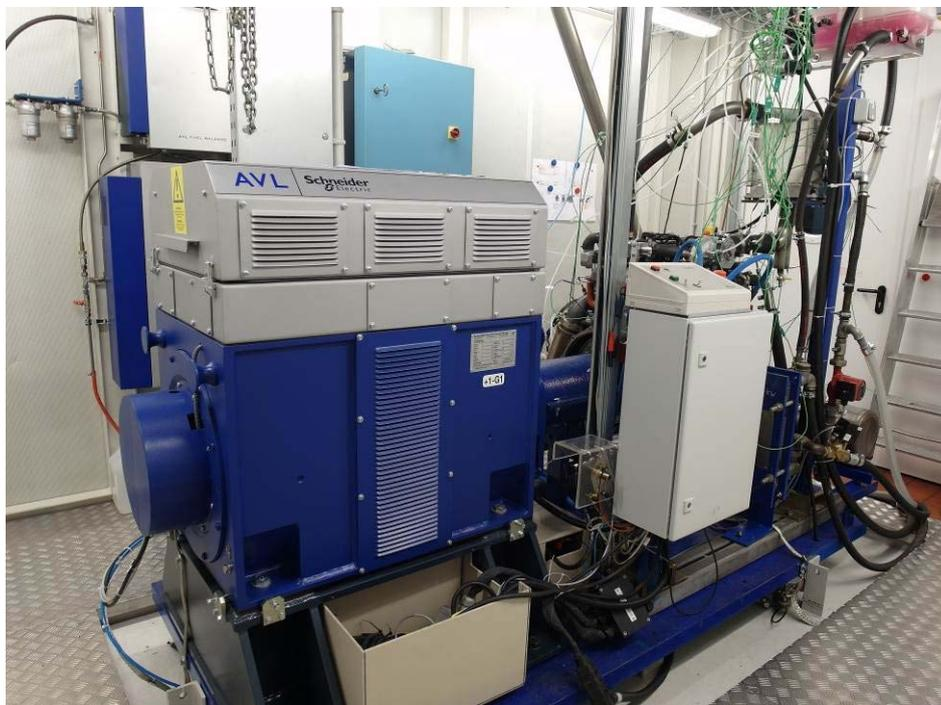
**Abbildung 4-15: Leistungsbremse AVL DynoRoad SL des Motorprüfstandes**
