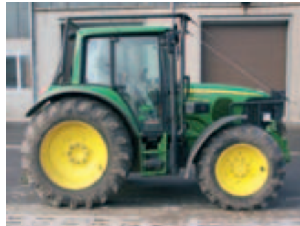
John Deere 6420 S, ausgerüstet für den Betrieb mit Mineraldiesel, Rapsöl und Biodiesel
