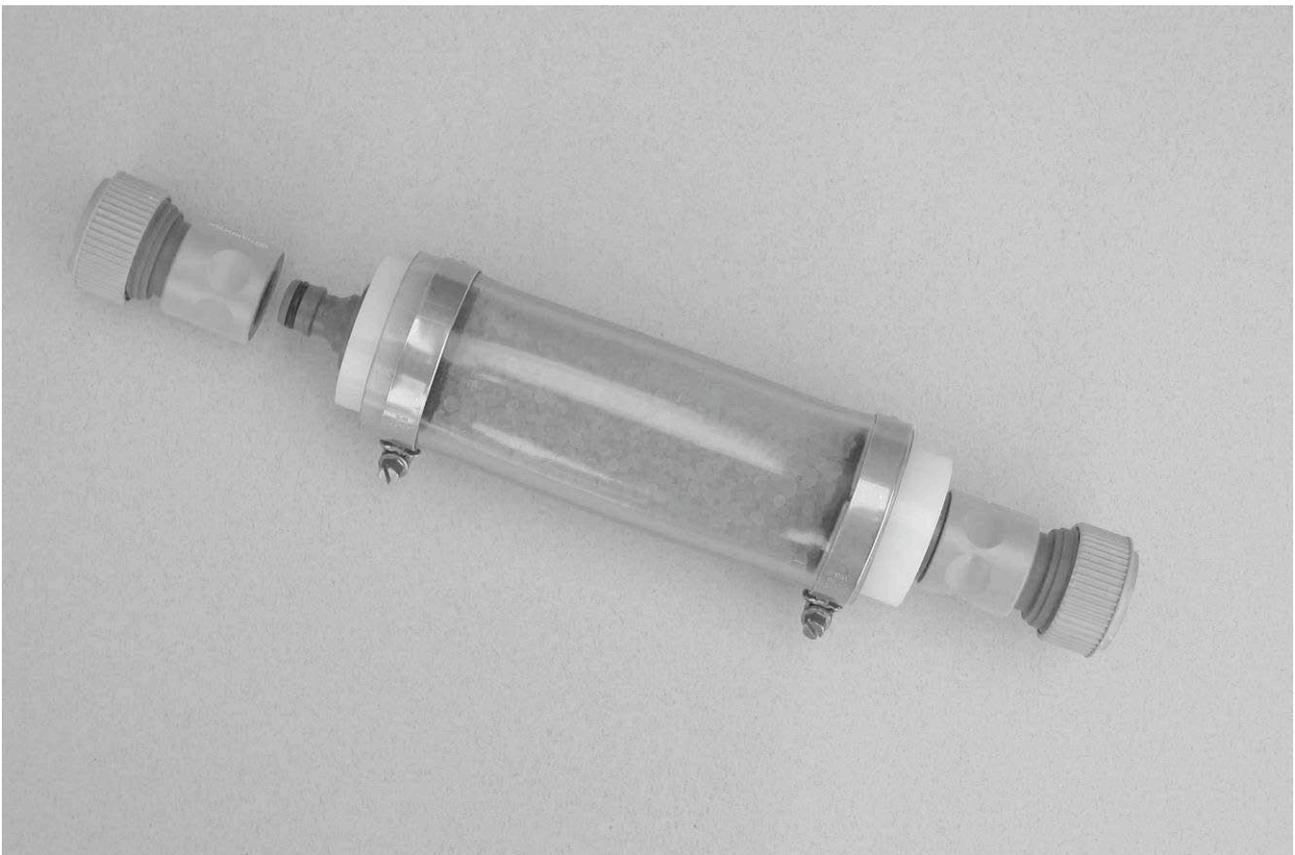
Bild 10: Einfache Trocknungsvorrichtung
