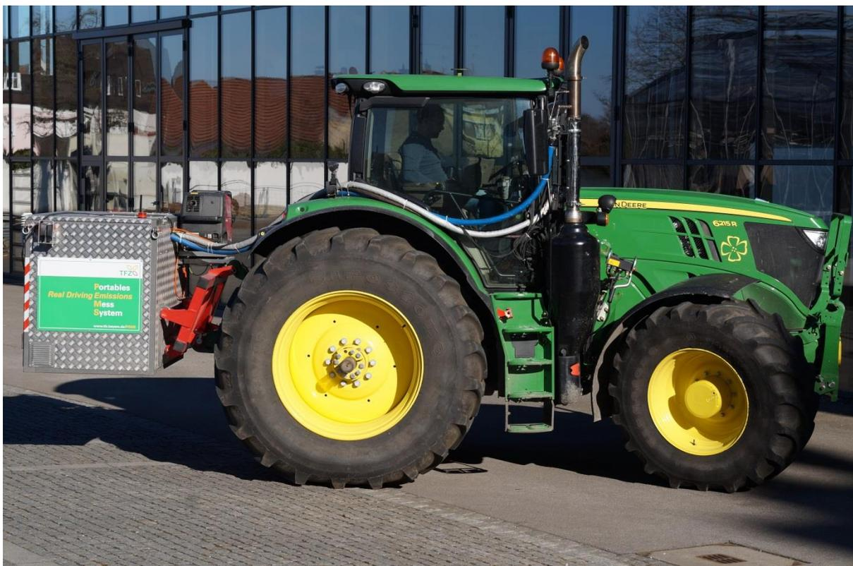
Abbildung 36: Pflanzenöltraktor John Deere 6215R mit portabilem Emissionsmesssystem
