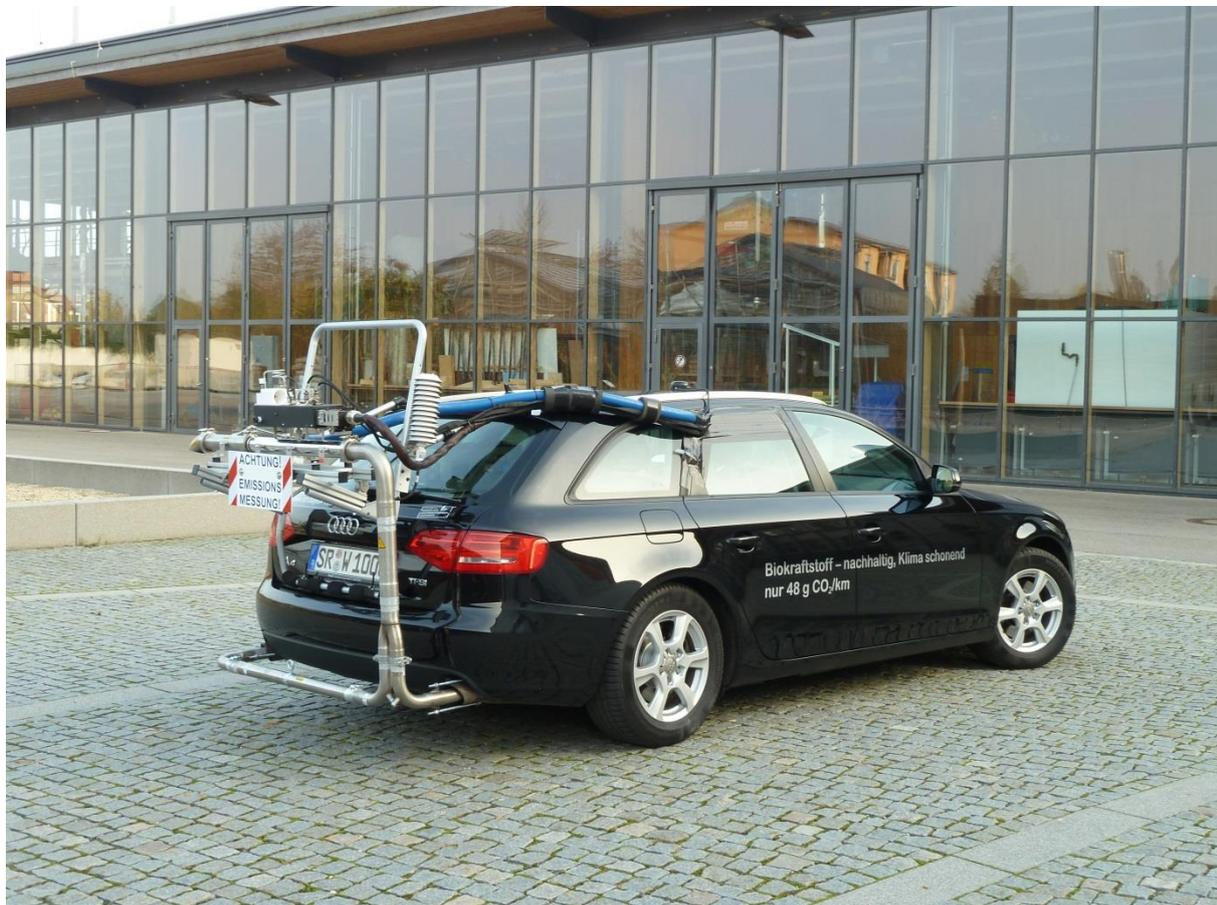
Abbildung 46: Audi Avant A4 2.0 TFSI flexible fuel mit PEMS
