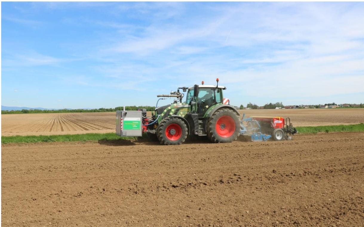
Abbildung 22: PEMS-Messungen mit den Anbaugeräten Kreiselegger und SÄmaschine im Mai 2017
