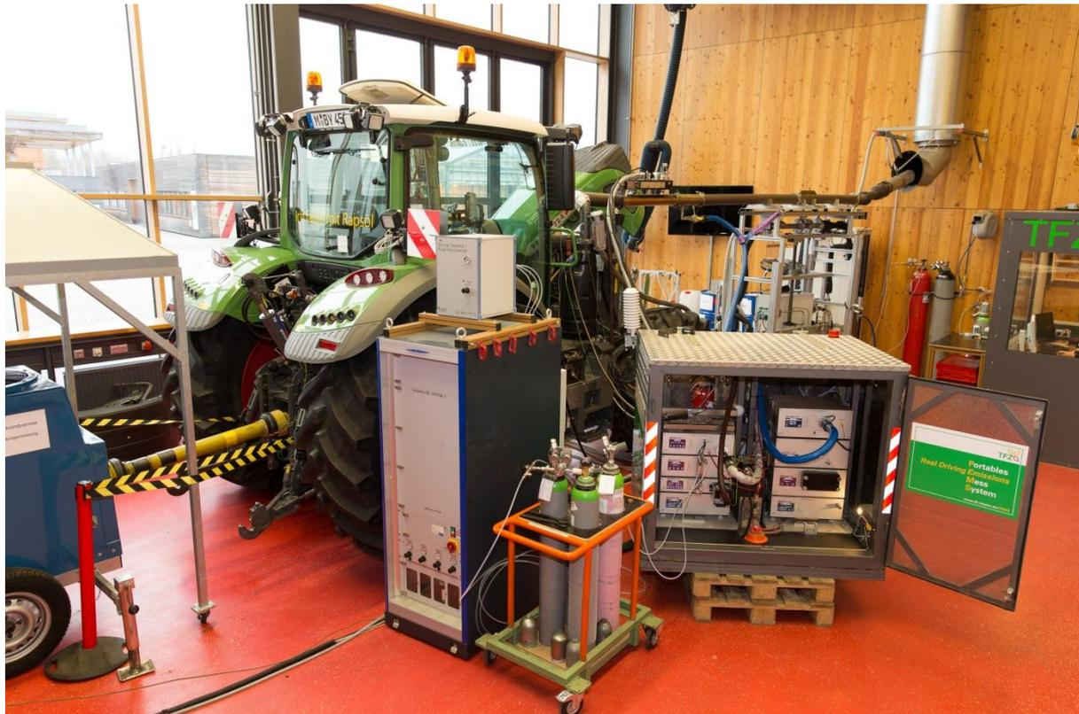
Abbildung 16: PEMS und stationäre Emissionsmesstechnik am Traktorenprüfstand
