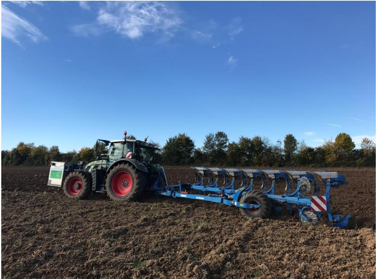
Abbildung 23: PEMS-Messungen mit dem Anbaugerät 7-Schar-Pflug im Oktober 2017
