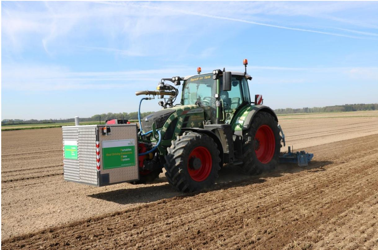
Abbildung 21: PEMS-Messungen mit dem Anbaugerät Kreiselegger im Mai 2017
