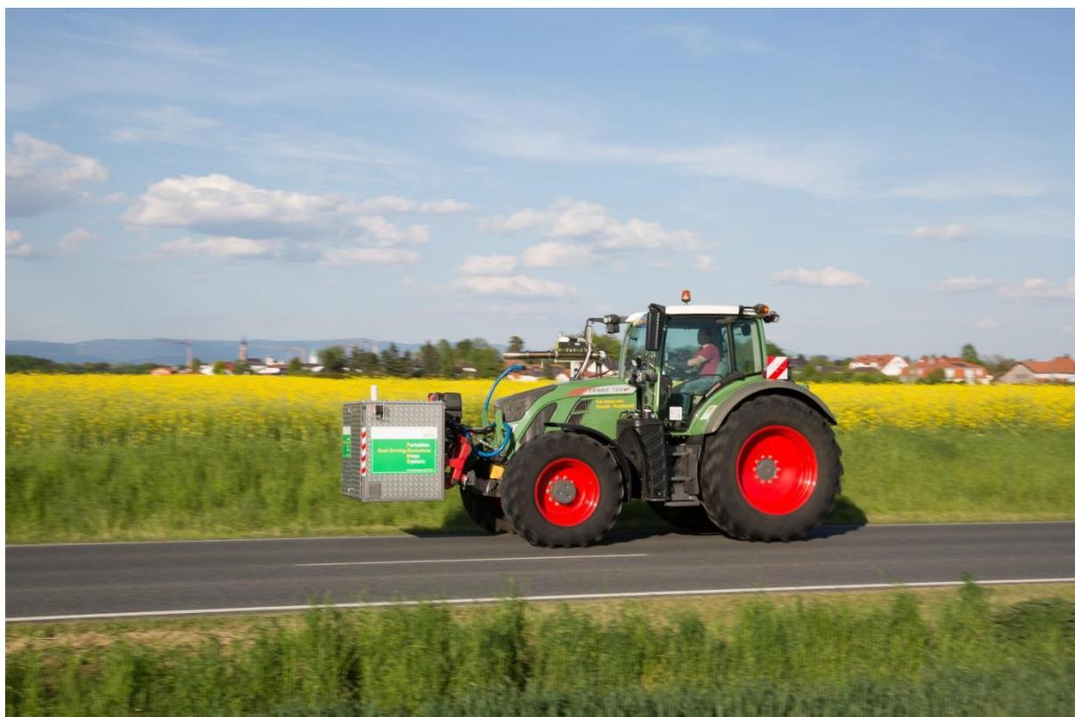
Abbildung 25: Fendt 724 Vario S4 mit PEMS im Frontanbau während der RDE-Messungen auf der Traktor-Teststrecke
