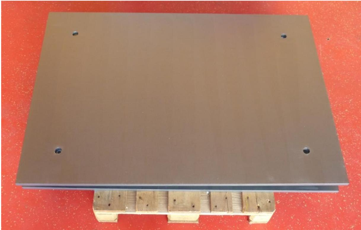
Abbildung 15: Ballastgewichte zur Montage an der PEMS-Box
