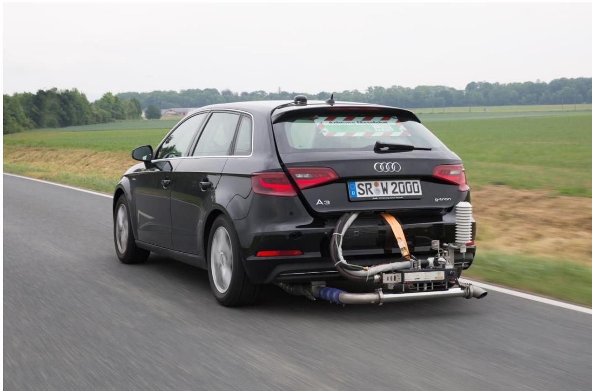
Abbildung 48: Audi A3 g-tron während der RDE-Fahrten mit installiertem PEMS
