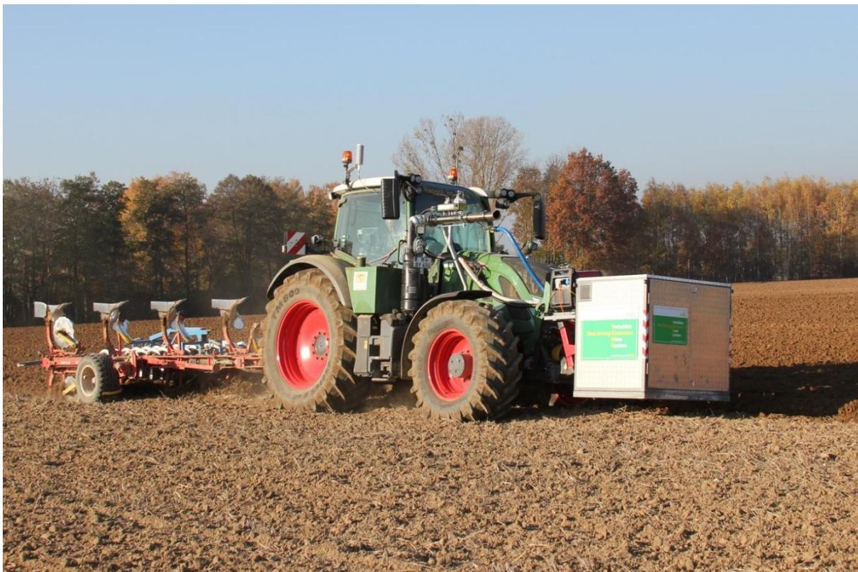
Abbildung 18: PEMS-Messungen auf dem Gutsbetrieb Mainkofen beim Pflügen im Oktober 2015
