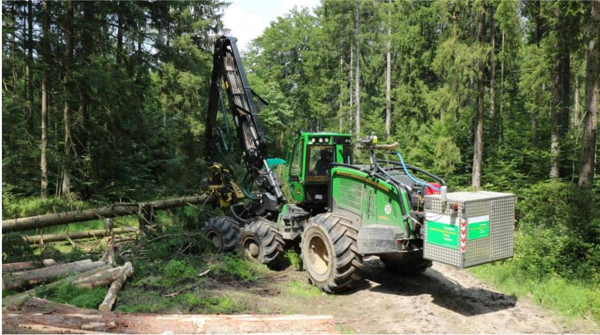
Abbildung 41: Harvester im Einsatz mit PEMS
