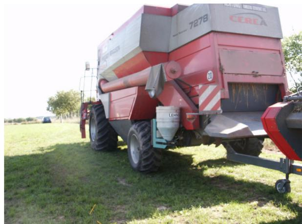
Bilder A5 u. A6: Hinten seitlich angebauter Schneckenkornstreuer bei beiden Prototypen
