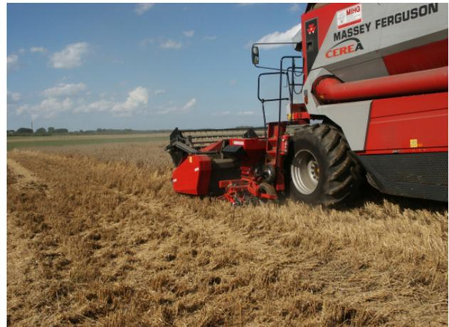
Bilder A3 u. A4: Mährescher MF 7278 mit angebautem Direktsaatgerät (Prototyp II)
