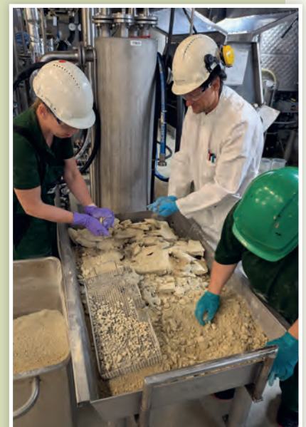
Nach der Entölung in der Filterpresse erhalten die Forschenden entöltes Rapskernkonzentrat mit hohem Proteingehalt
