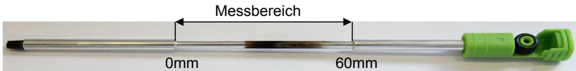
Aluminium-Heizstab nach Test mit oxidativen Belägen
